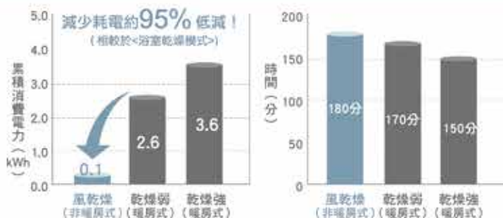
浴室乾燥時間與耗電量 (測試機種：V-241BZ-TWN)
